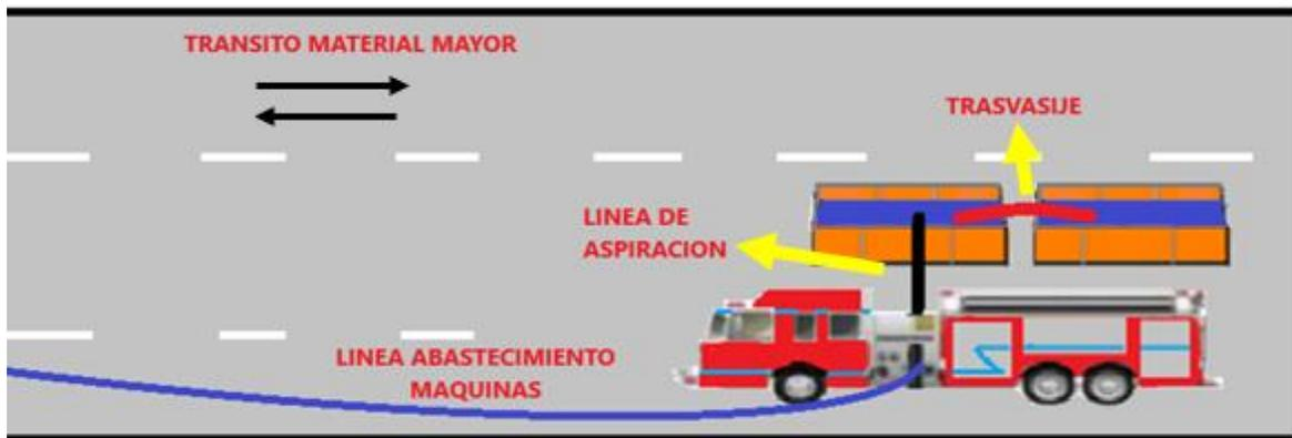
con la misma bomba de la máquina principal de abastecimiento empleando mangueras de 52 mm para usar la menor cantidad de agua posible en este mecanismo.
